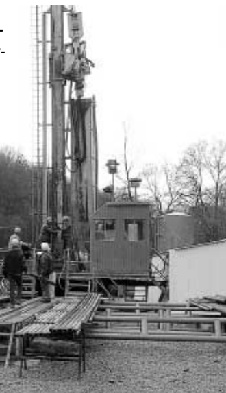
Magtűlfúrásos feszültségmérés a Bak-5 jelű sekélyfúrásban
