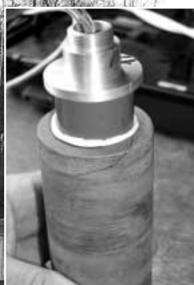
Magtűlfúrásos feszültségmérés a Bak-5 jelű sekélyfúrásban
